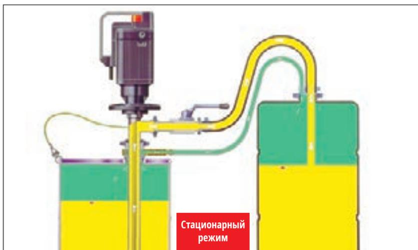
В наши дни очень большое внимание уделяется снижению загрязнения воздуха. Компания Lutz делает все, что в ее силах, для охраны окружающей среды. Мы доработали наш бочковой адаптер, предотвращающий утечки, встроив его в комплексную газоотводную систему. Вредные газы и пары, образующиеся при перекачке опасных жидкостей, не выходят за пределы практически полностью замкнутой системы, обеспечивающей необходимую компенсацию давления без утечек в атмосферу.
